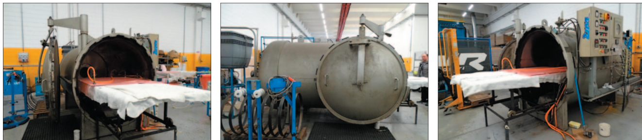
製作 Aeon 2.0 碳纖維架的高壓焗爐，與真人相比，圖中可見其體積有多巨型。
